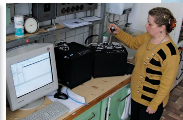
Прибор для измерения удельной поверхности дисперсных и пористых материалов Sorbi-M
