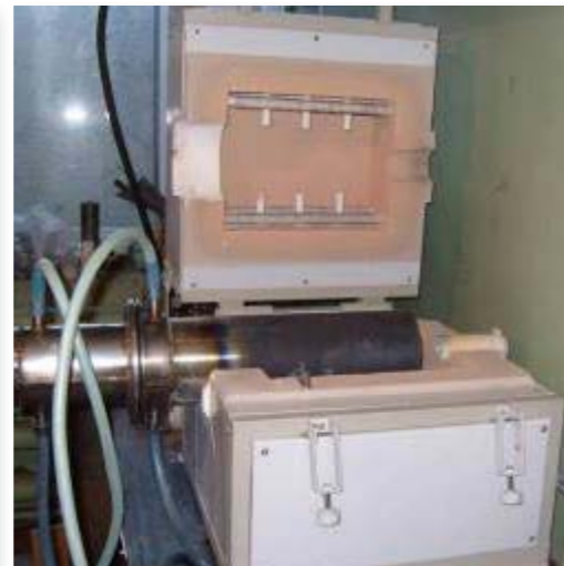
Установка для дегидрирования титана
