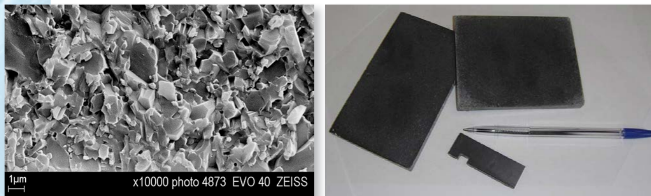
Горячепрессованная керамика, изготовленная из композитных порошков \text{Si}_3\text{N}_4 \cdot \text{MgO} ( \text{Y}_2\text{O}_3 )
