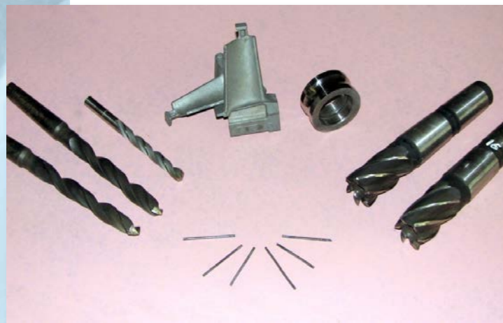
Покрyтия на различные детали и инструменты нанесены СВС-электродными материалами
