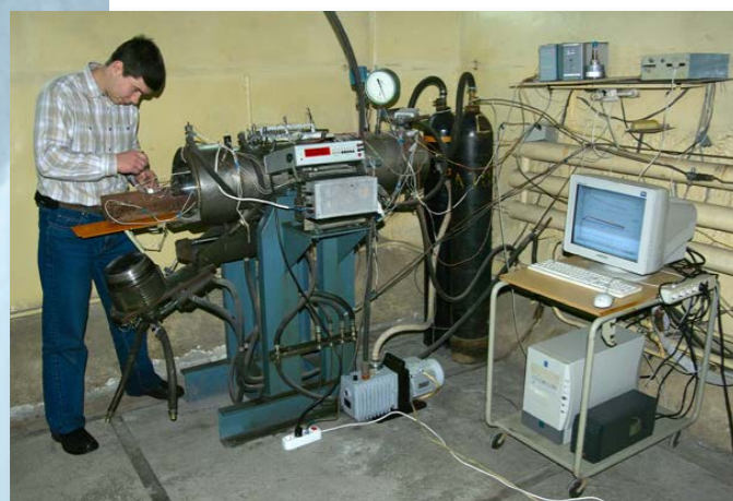
Уникальный стенд на базе реактора СВС-30 с компьютерной измерительной системой
