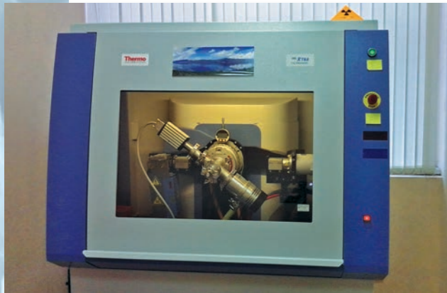
Порошковый рентгеновский дифрактометр ARL X'TRA (базовая система X'TRA с детектором Пельтье, Basic X'TRA System with Peltier Detector)
