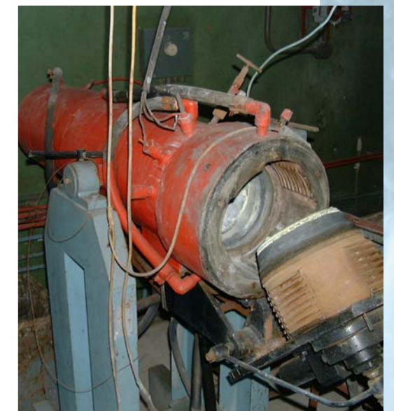
Стенд для натурных испытаний взрыва водородо-воздушных и метано-воздушных смесей («КЕССОН»)
