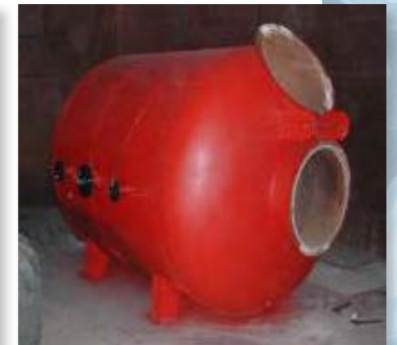
Стенд для натурных испытаний взрыва водородо-воздушных и метано-воздушных смесей («КЕССОН»)
