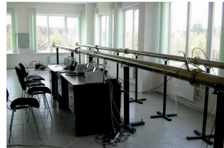
Испытательно-демонстрационный стенд для изучения процессов горения, взрыва и детонации
