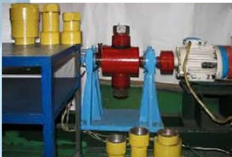
Опытно-промышленные центробежные установки Ускорение — до 1000 g, рабочая загрузка — до 6 кг
