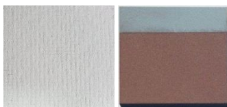
Керамическая огнезащита (слева) и металлическая молниезащита (справа) изделий из карбонового композита
