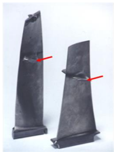
Упрочнение лопаток авиадвигателя металлокерамическим композитом
