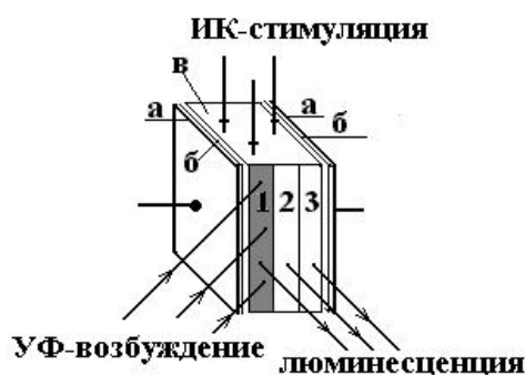
рис.1. принципиальная схема измерительной ячейки: а – высоковольтные электроды, б – слюдяные прокладки, в - исследуемый образец.
