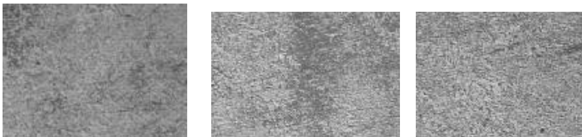
рис.1. Фотографии микроструктуры при увеличении 100 х : а) наплавленный материал; б) зона сплавления; в) основной металл.
