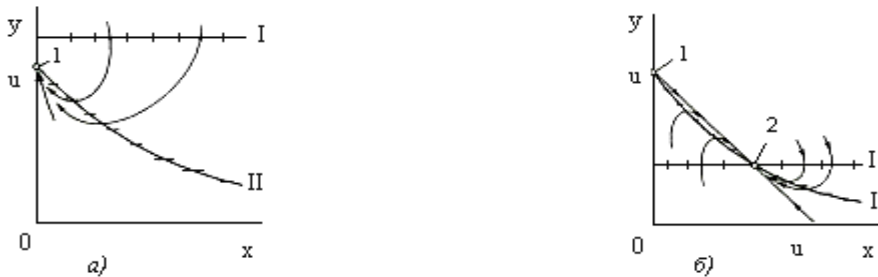
рис.1. а) точка 1 – устойчивый узел; б) точка 1 – седло, 2 – устойчивый узел; I – вертикальная изоклина, II – горизонтальная изоклина.
