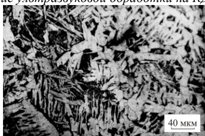
рис. 2. Структура сварного шва
