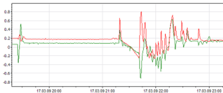
рис.2 Запись интенсивности течения в полости при стыковке МКС с Шаттлом STS-129
