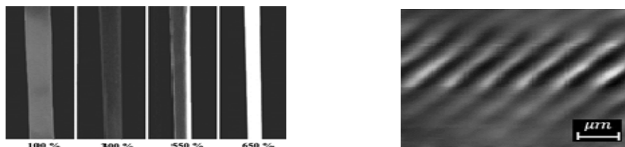
рис. 2. Образование «milk phase»: микрофотографии лопаток на различных этапах деформации (а) и изображение поверхности лопаток в состоянии «milk phase», зарегистрированное с помощью атомного силового микроскопа (б).
