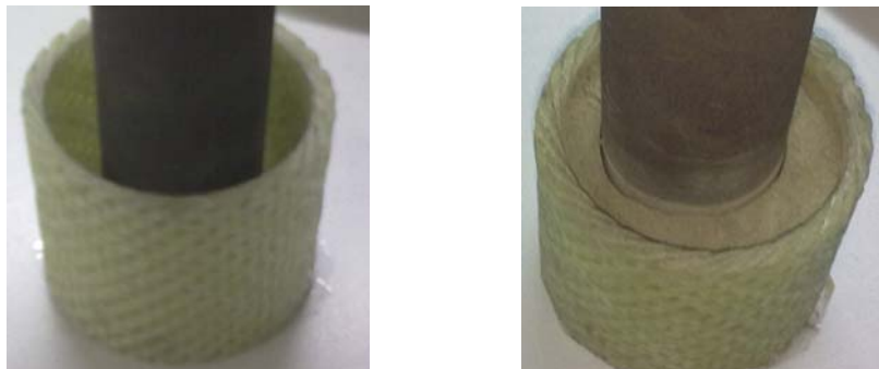
рис.2. Фильтр-патрон из СВС материала (слева) с наполнителем из механоактивированного цеолита (справа)
