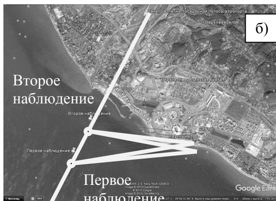
рис.1.а) Плоская система координат, введенная для определения скорости объекта (самолета) и изменения его координат. Точка С – положение объекта, h – расстояние до объекта, точки О,С положения камер. б) Геометрическое построение для определения параметров траектории самолетов, наложенное на спутниковый снимок.
