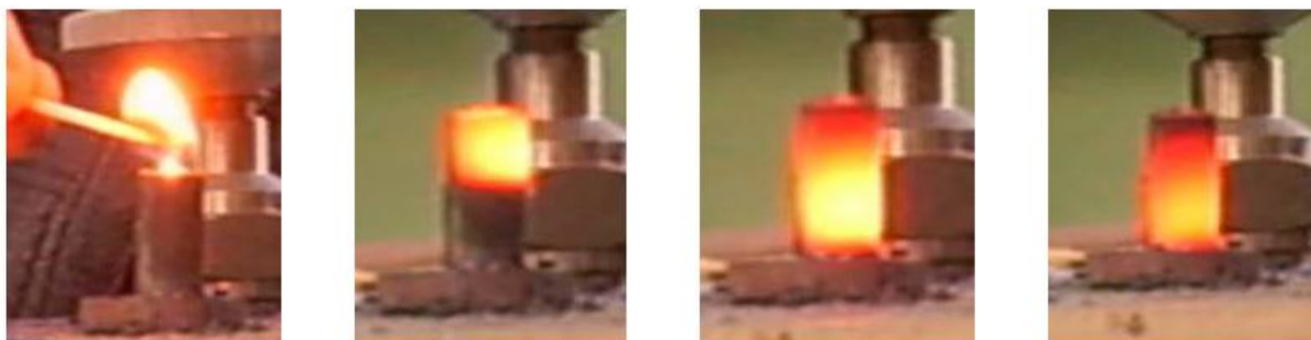
рис.1. Послойное горение образца алюмомагнезиальной шпинели диаметром 20 мм с добавкой бора 2% мас.
