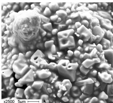
рис.2. Микрофотография продуктов СВ-синтеза алюмомагнезиальной шпинели (2% мас. бора).
