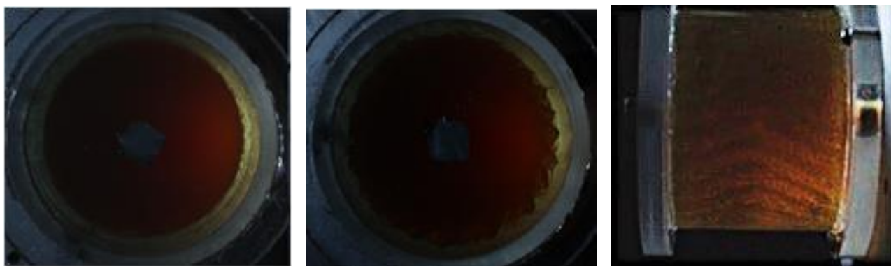
рис. 2. Вид границы раздела жидкостей в поперечном сечении (а и б) и сбоку (в)
