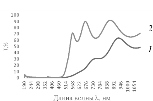
рис. 1. Спектры пропускания многослойных структур CdS-PbS с толщиной подслоев CdS: 1 – 12
