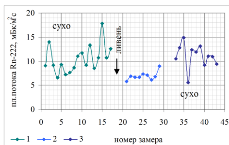
рис. 1. Плотность потока радона-222 из почвы в атмосферу на плато Шаджатмаз (КВНС ИФА) в зависимости от осадков: 1)4.08.21;
