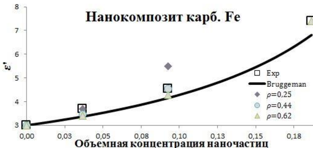
рис.1. Зависимость действительной части эффективной диэлектрической проницаемости от объемной концентрации наночастиц в композите с учетом агломерации наночастиц
